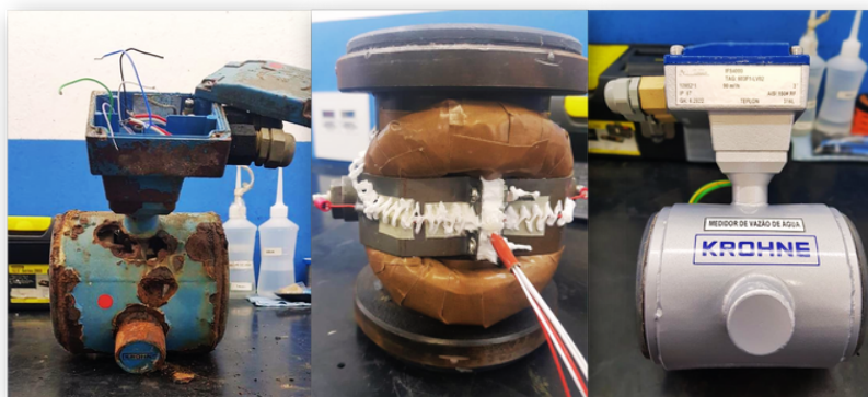
Reparo e pintura em sensor Eletromagnéticos
