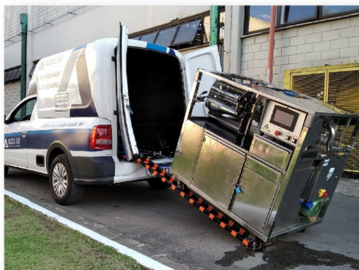
Skid para calibração em Campo
