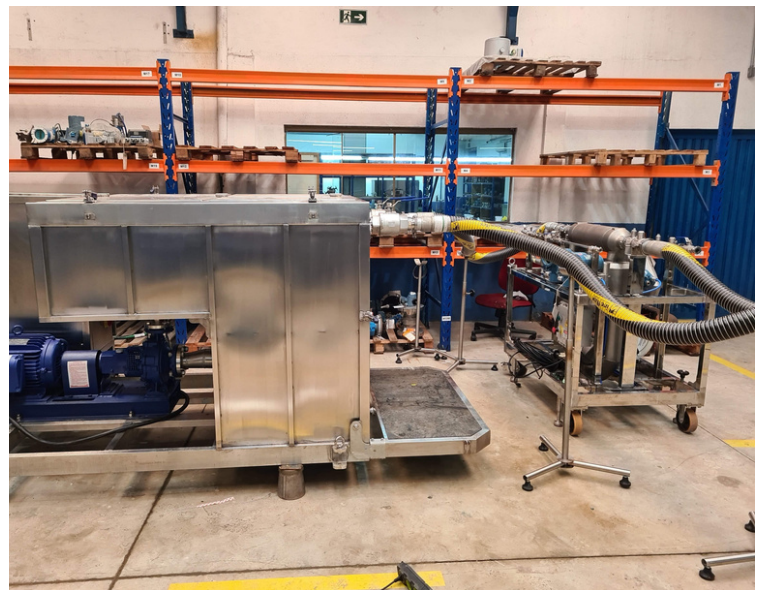
Skid para calibração em Campo
