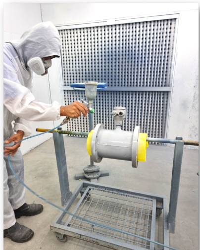
Pintura de Medidores
